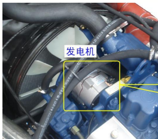
发电机 B+ 接线柱接的粗红线
