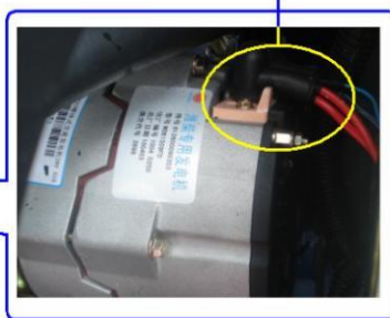
发电机 B+ 接线柱接的粗红线
