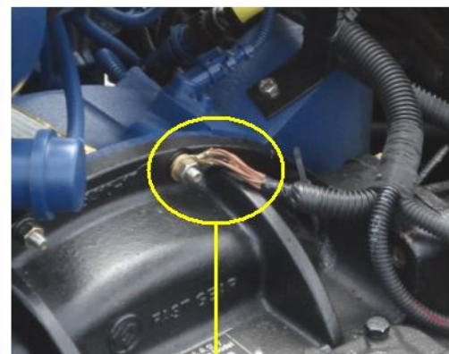
发动机飞轮壳搭铁点
